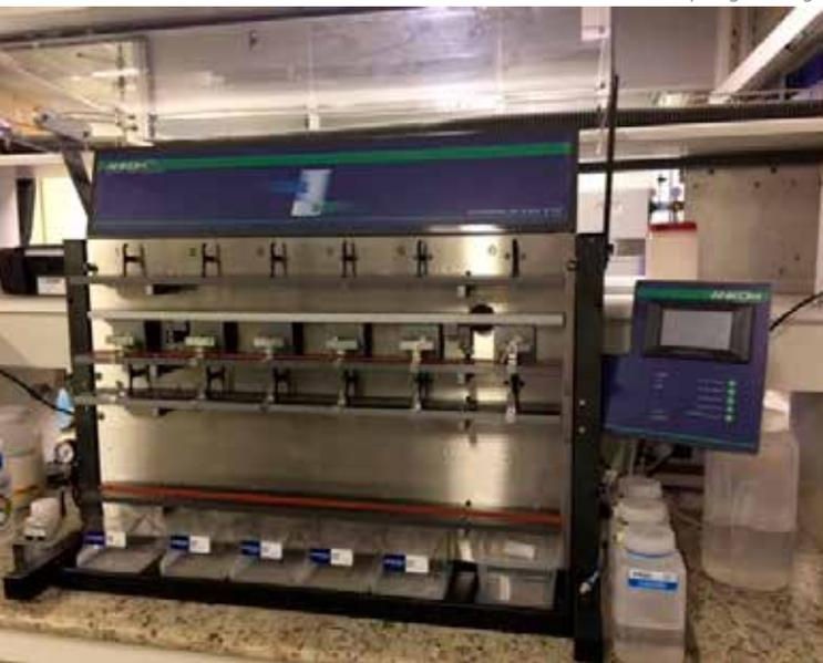
Analizador automático para análise de fibra alimentar está entre os equipamentos adquiridos para equipar o laboratório da Unidade.
