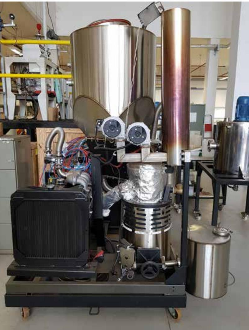
Equipamento para gaseificação de resíduos de biomassa para produção de energia elétrica.
